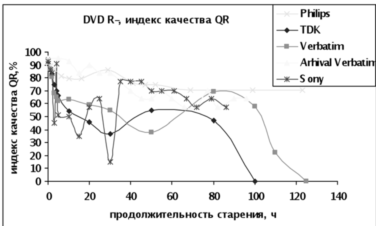
Рис. 1. Изменение индекса качества QR в процессе светового старения для DVD различных производителей:
