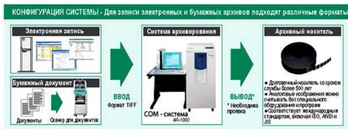
Рис. 1. Этапы получения информации на микрографических носителях с использованием СОМ-систем
