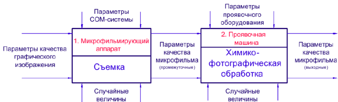
Рис. 3 – Представление операции микрофильмирования КОМ-системой в виде совокупности двух переходов с промежуточными параметрами качества
