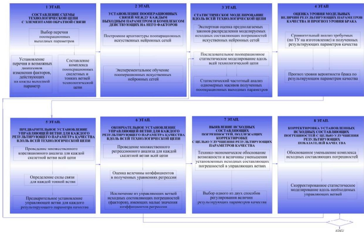
Рис. 1 – Схема алгоритма реализации разработанной статистической модели управления качеством многооперационных технологических процессов
