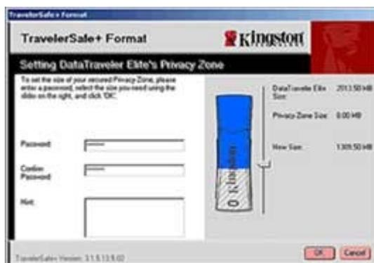
Программный интерфейс, позволяющий закрыть паролем доступ к выделенной части памяти Kingston DataTraveler Elite
