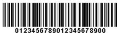
Рис. 3 – Пример штрих-кода Interleaved 2 of 5 (ITF)
