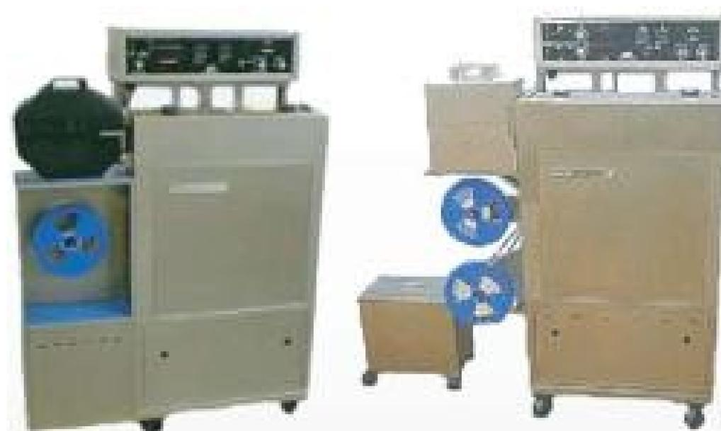
Новый MiniLabMaster™ Plus от компании Crowley обеспечивает полный контроль над процессом проявки пленки. Проявочная машина оснащена микропроцессорным модулем контроля температуры и цифровым модулем контроля скорости. Автоматическая система пополнения смешивает и пополняет реактивы, что позволяет:
