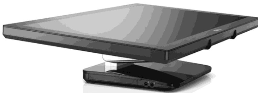
Рис. 5. Высокоразрешающий ЖК-монитор в горизонтальном положении (функция съемочного стола)
