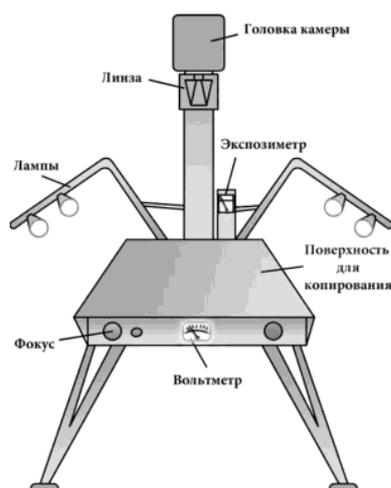
Рис. 3. Общая схема микрофильмирующей камеры
