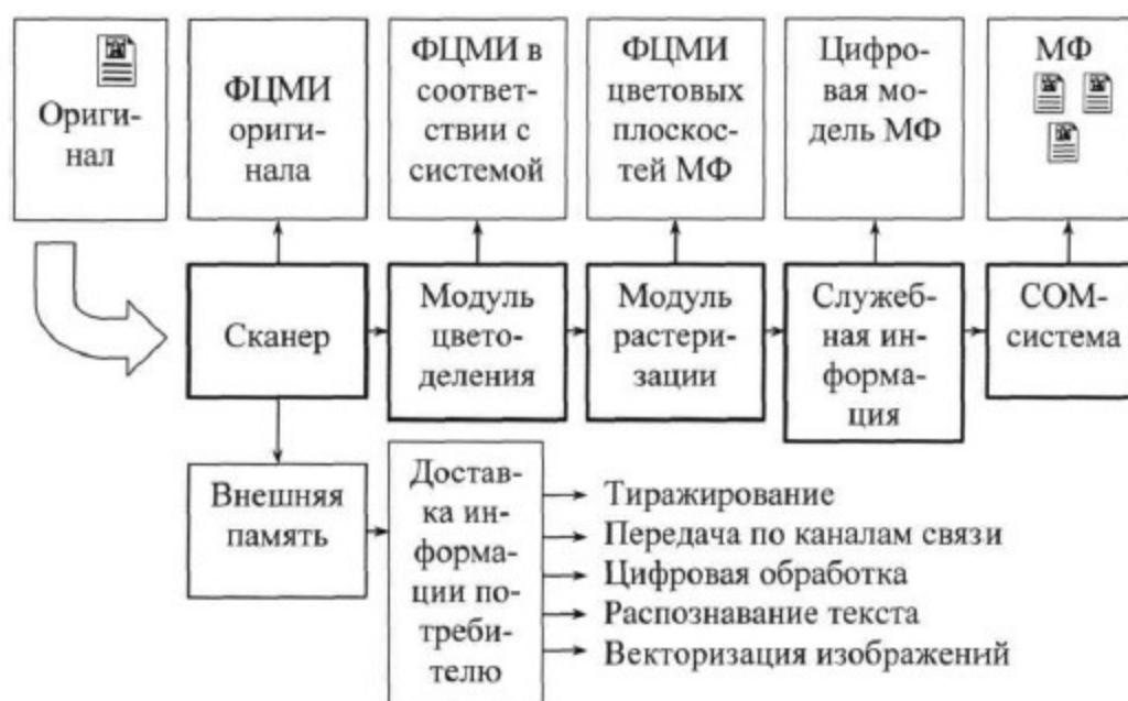
Рис. 1. Процесс формирования микрофильма
