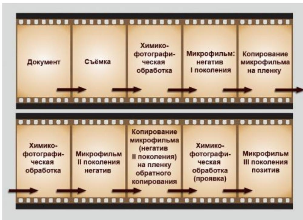
Рулонные микрофильмы изготавливаются в трех поколениях. Основные размеры и размещение микроизображений регламентируется ГОСТ 13.1.104-93, а качество и технология изготовления – ГОСТ 13.1.102-94. На схеме показан процесс изготовления трех поколений рулонных микрофильмов в соответствии с требованиями ФЦП по созданию страхового фонда микрофильмов.
