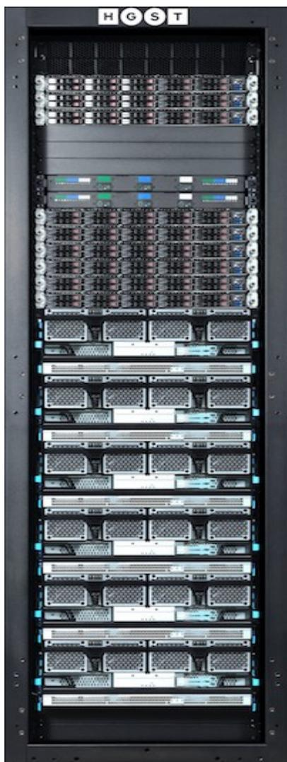
HGST Active Archive (далее AA) – представляет собой готовую к работе, укомплектованную систему хранения с предустановленным ПО, в формате стойки 42U. В ней есть три управляющих узла с SSD и шесть серверов хранения, к которым подключены шесть JBOD, по 98 дисков 8 TB в каждом (HGST Helium). JBOD управляются как блочные устройства хранения, по SAS. В управляющих серверах стоят SSD достаточной емкости, чтобы обслужить метаданные по более чем 1 800 000 000 объектов данных в расчете на одну стойку AA.
