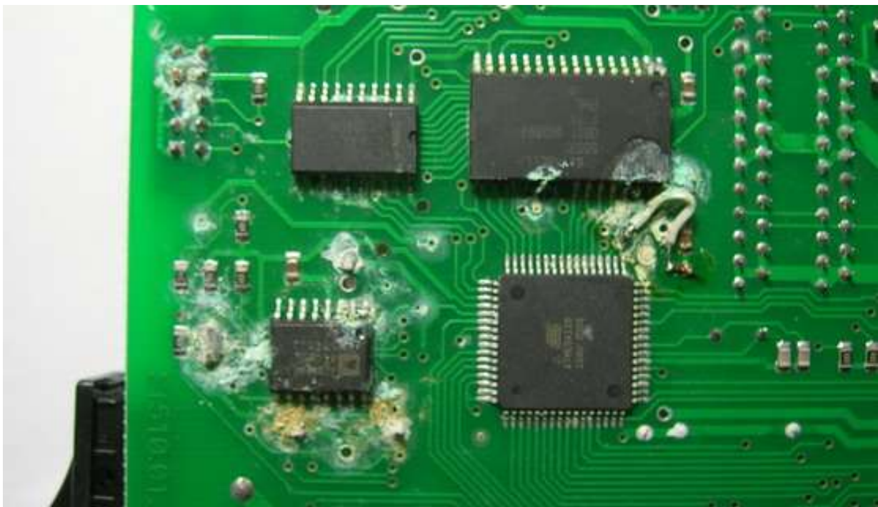
Рис. 7 – Результат дії мікроорганізмів на плату HDD накопичувача
