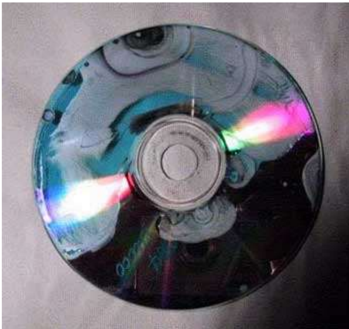
Рис. 3 – Вплив мікроорганізмів на оптичний компакт-диск
