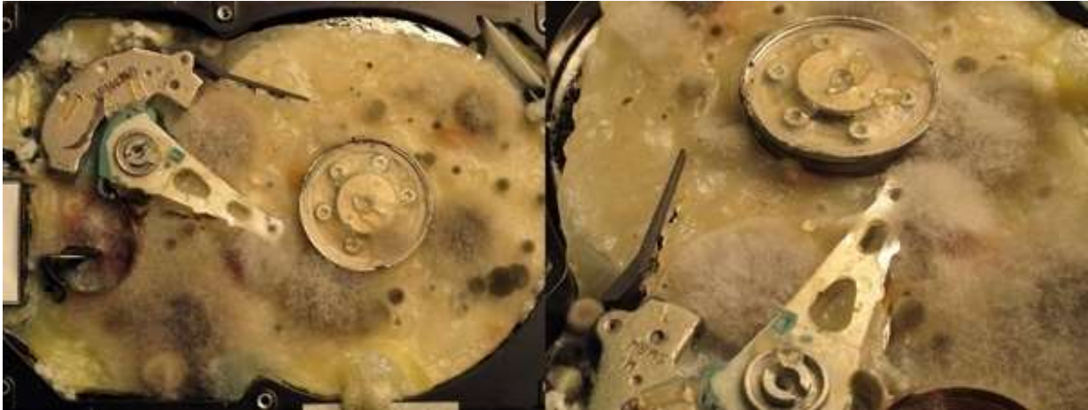
Рис. 4 – Результат дії мікроорганізмів на HDD накопичувач
