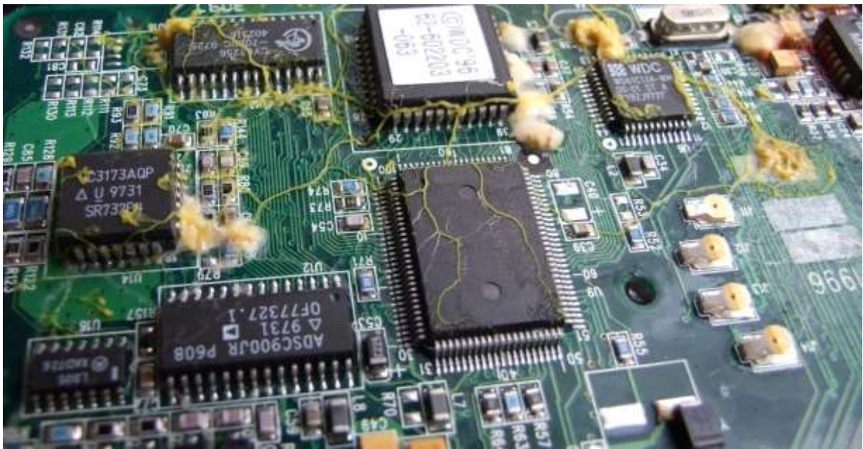
Рис. 6 – Результат дії мікроорганізмів на процесорний модуль
