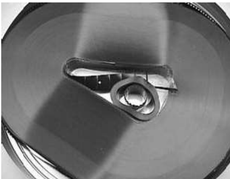
Рис. 4 – Деформація рулонного фільму при зберіганні у вертикальному положенні без осердя
