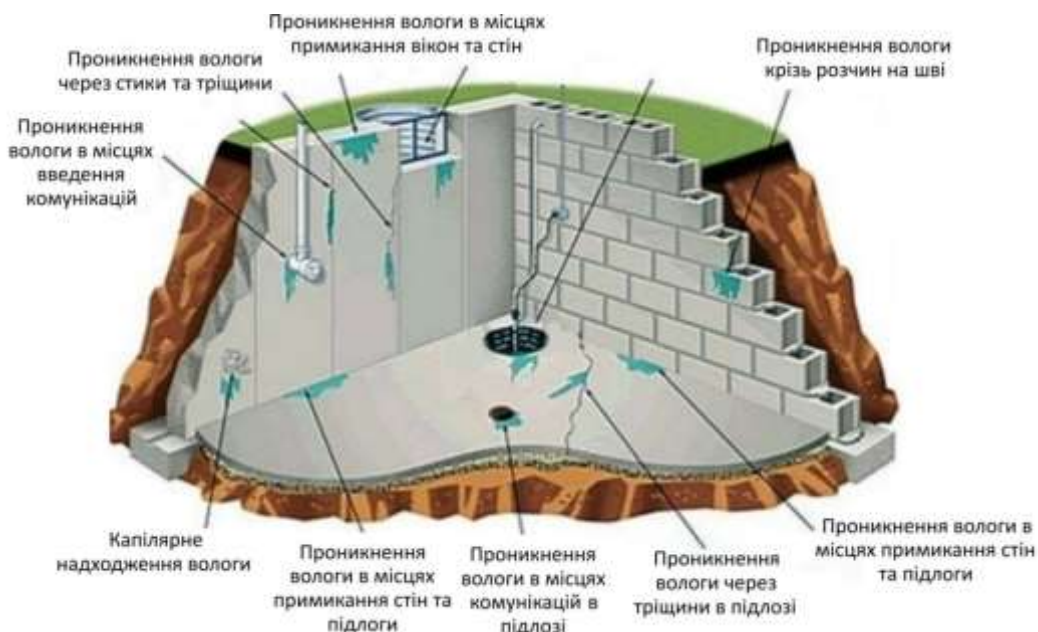
Рис. 1 – Джерела проникнення води до приміщень споруди, що розташовані нижче рівня землі
